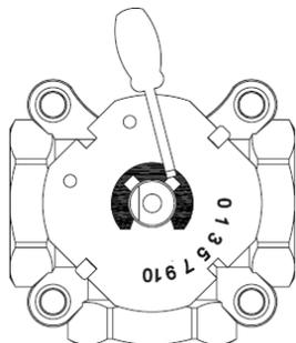
При необходимости, пластина с градуированной шильдой может быть переставлена в другое положение. Для этого необходимо снять рукоятку управления и с помощью отвертки снять пружинную шайбу со штока.
